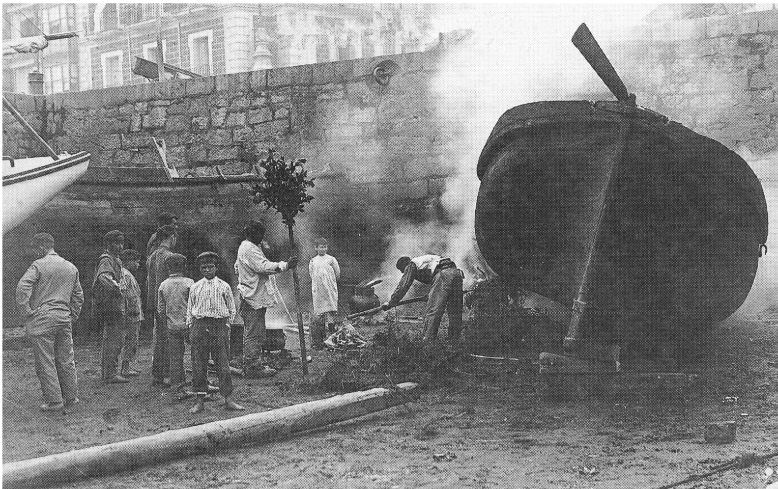
Carenado, por el método tradicional, de una lancha mayor en el puerto de Castro Urdiales.
